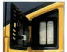
Filtro externo do ar condicionado
