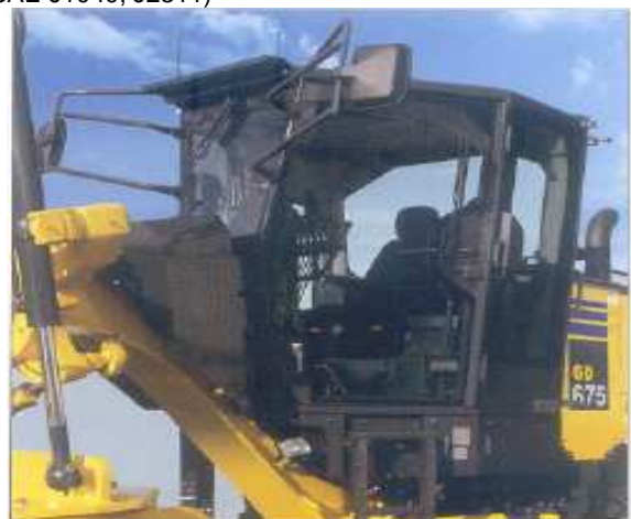
Cabina ROPS (Estructura Protectora Antivuelco) (Equipada con desempañador y limpiaparabrisas intermitente)
